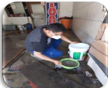
Recolección de agua residual de la entrada a la red de alcantarillado
