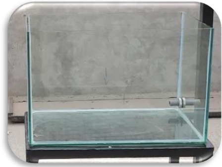
Biofiltro de material de vidrio de 6 mm de espesor
