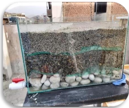
Colocación del material filtrante colocando malla mosquitera por cada capa
