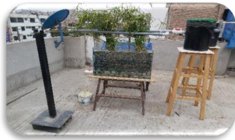
Descarga de agua de caño a través del biofiltro para el crecimiento de las raíces
