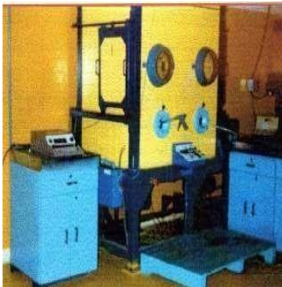
Figura N° 37 – Momentos en que se mide la actividad (mCi) del producto final en las cámaras de ionización, aquí es etiquetado y embalado para ser enviado hacia su destino
