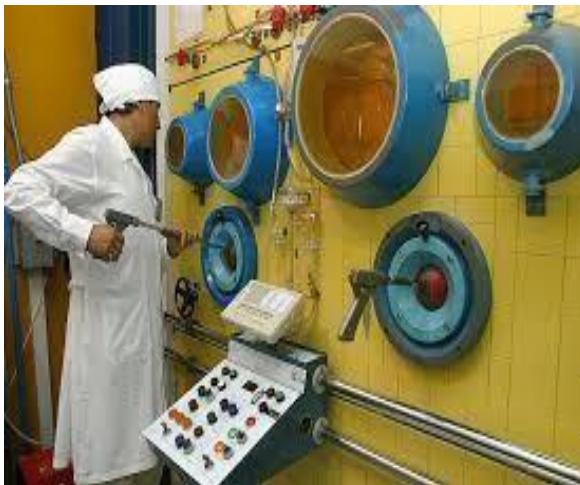
Figura N° 7 – Telemanipuladores de la celda caliente
