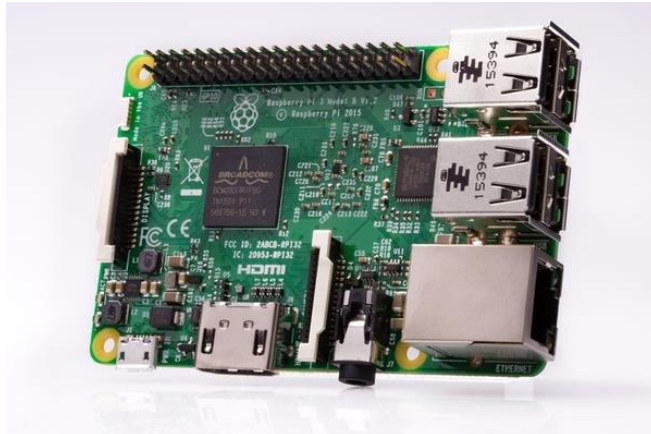
Figura 2.1 Raspberry pi 3B: Computadora de placa única con LAN inalámbrica y conectividad Bluetooth [28].
