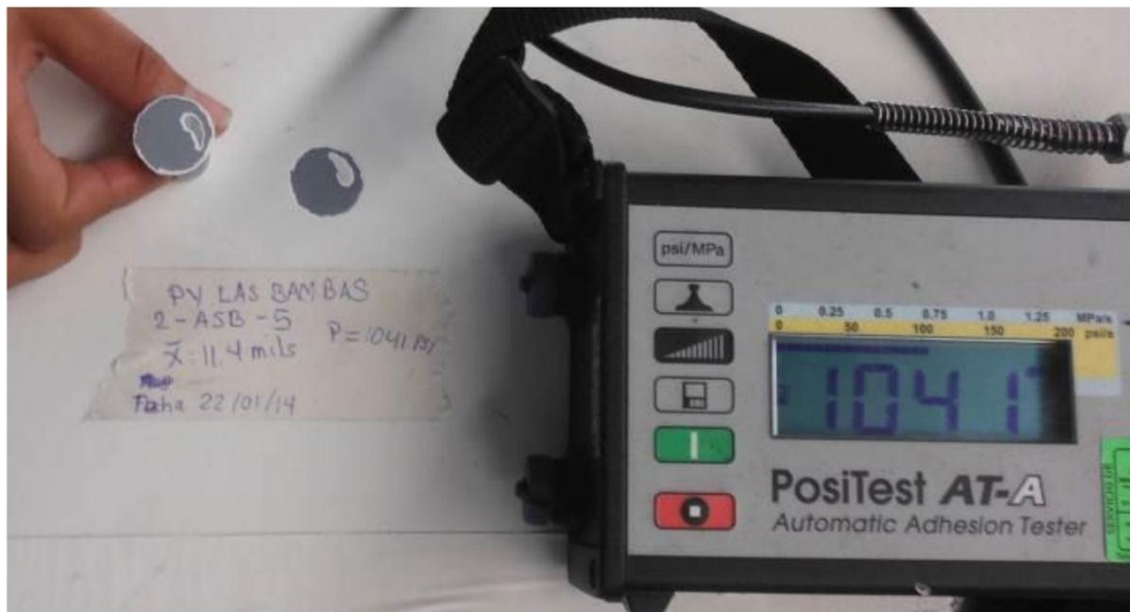
Ensayo de adherencia conforme
