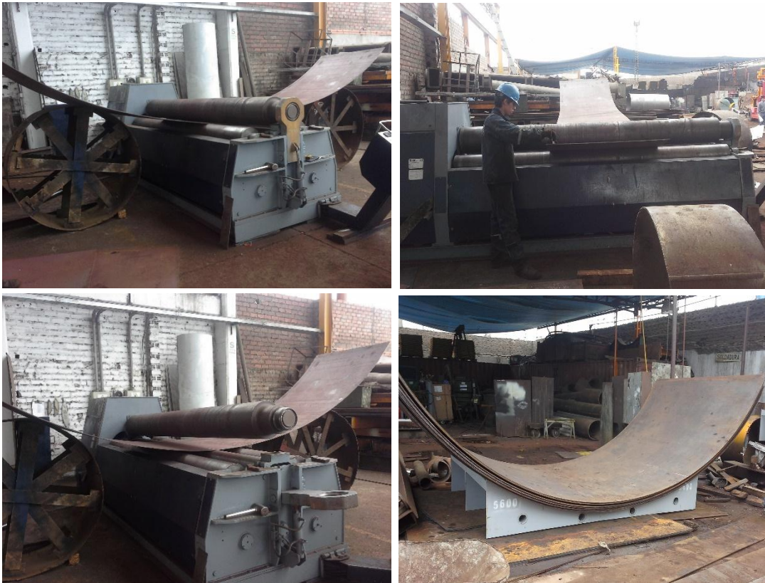
Rolado de elementos componentes del tanque de planta de cal
