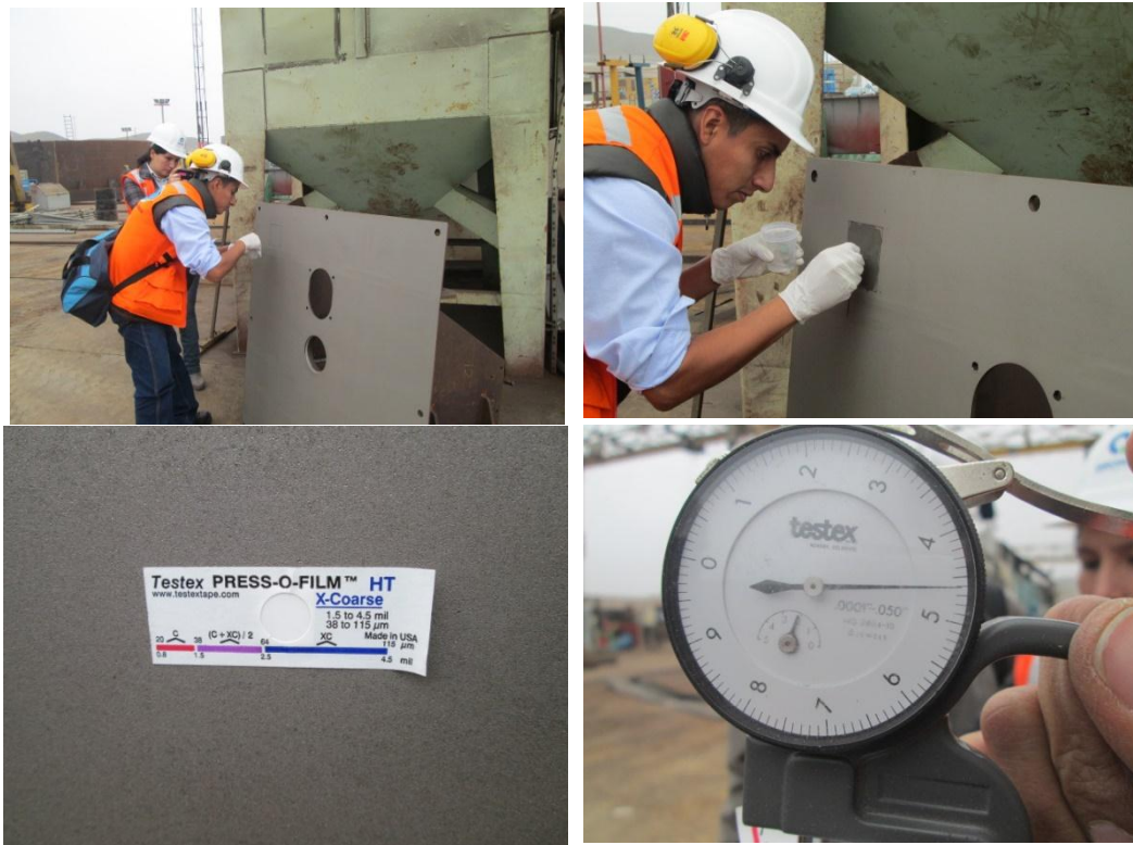
Control de rugosidad para inicio de tratamiento superficial
