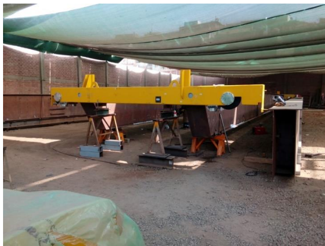
Figura 48 Pre ensamble de puente grúa
