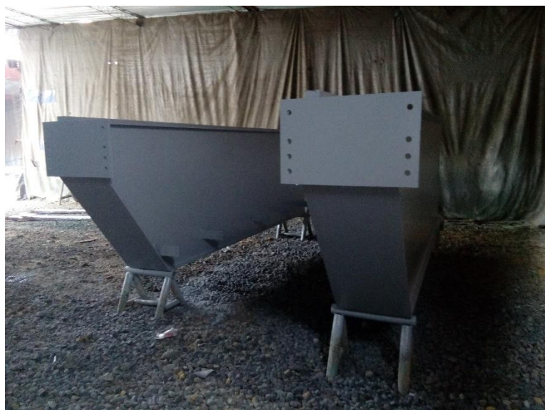
Figura 58 Recubrimiento superficial base de viga puente grúa
