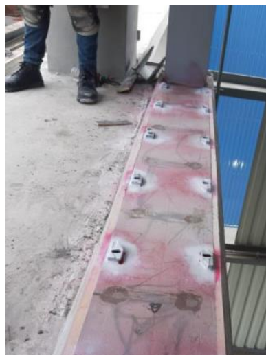
Figura 64 Inspección de soldadura por líquidos penetrantes
