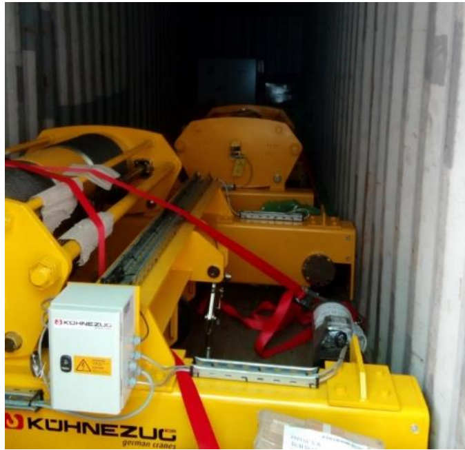
Figura 30 Equipos de componentes puente grúa 15TN
