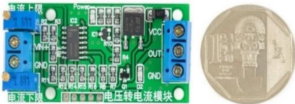
Figura 47: Relación de tamaño entre la tarjeta conversora y una moneda de un nuevo sol.
