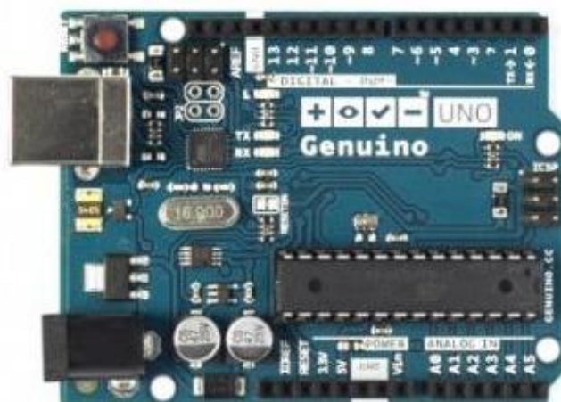
Figura 43: Arduino Genuino UNO.
