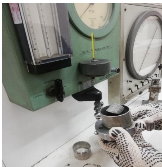
Figura 35: Ubicación de la muestra a evaluar en el Permeámetro a Gas Ruska.
