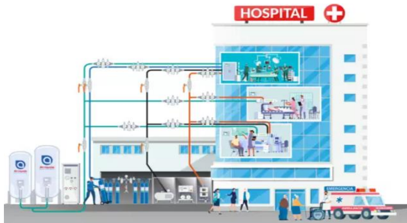
Figura 3.27 Suministro de gases médicos a través de los dispositivos biomédicos (Air Liquide HEALTHCARE, 2022).
