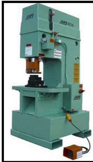
Figura 2. 3. Modelo de Marco Estructural Prensa de Troquelado
