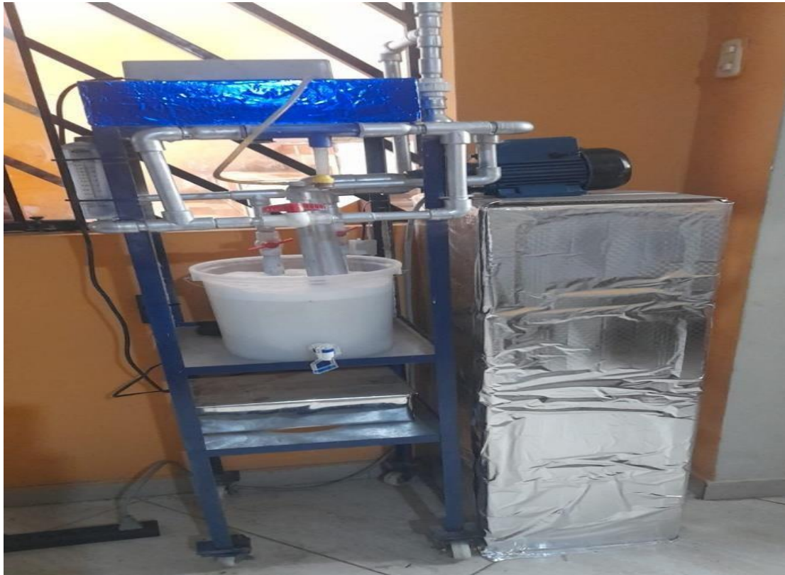
Anexo 8. Foto de la construcción del equipo POA (proceso de oxidación avanzada) terminada su construcción.
