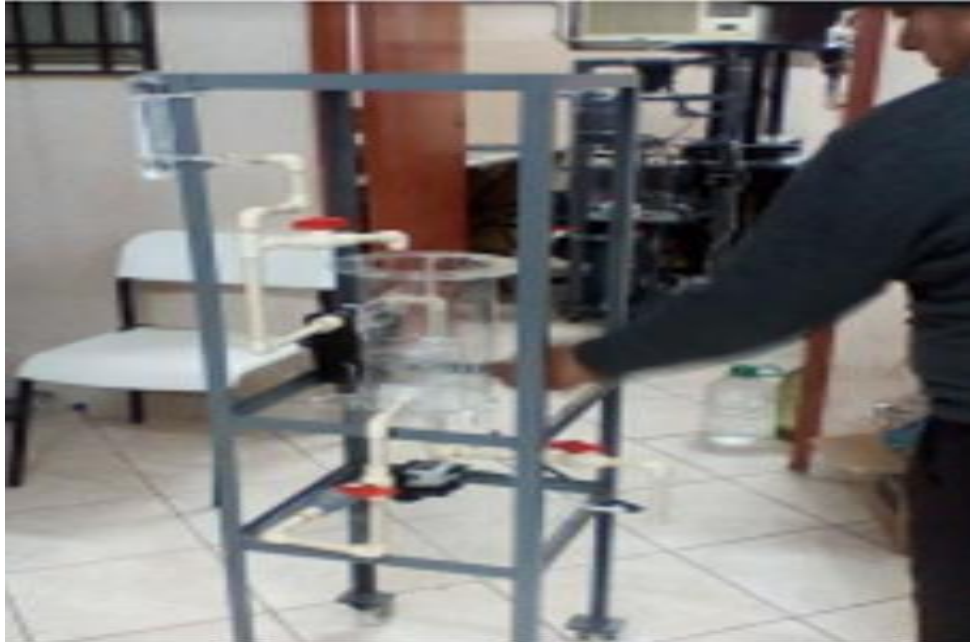
Anexo 7. Foto de la construcción del equipo POA (proceso de oxidación avanzada) en las instalaciones del laboratorio de operaciones unitarias LOPU bajo supervisión.
