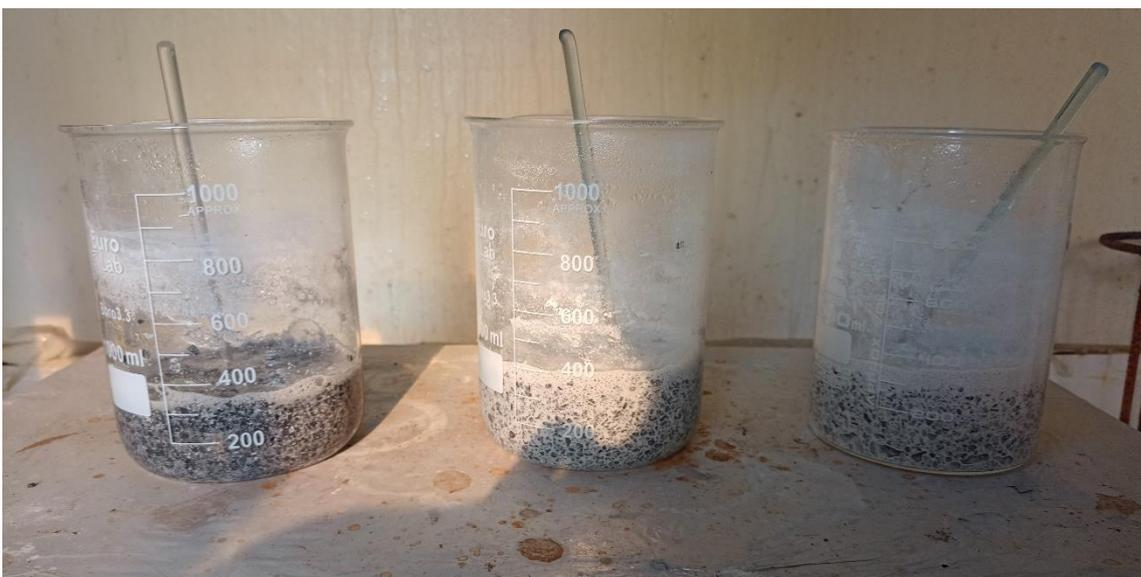
La fase sólida que queda en el vaso se sometió a calcinación en la mufla, a una temperatura de 400 °C por una hora, se retiró y se dejó enfriar. Posterior a ello se lavó el compósito para remover el exceso de dióxido de titanio que no quedó impregnado y finalmente se secó en la estufa. El carbón secado se dejó en las bandejas para que se enfríen y se revise que el impregnado haya sido uniforme, así como se muestra en la figura 9.
