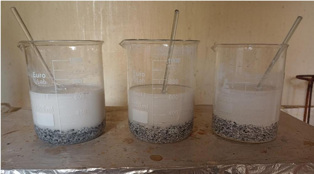
La mezcla en agitación constante se calentó hasta que se evaporó el agua y se obtuvo únicamente la fase sólida. La agitación se detuvo cuando aproximadamente la tercera parte del volumen de agua se evaporó como se observa en la figura 8.
