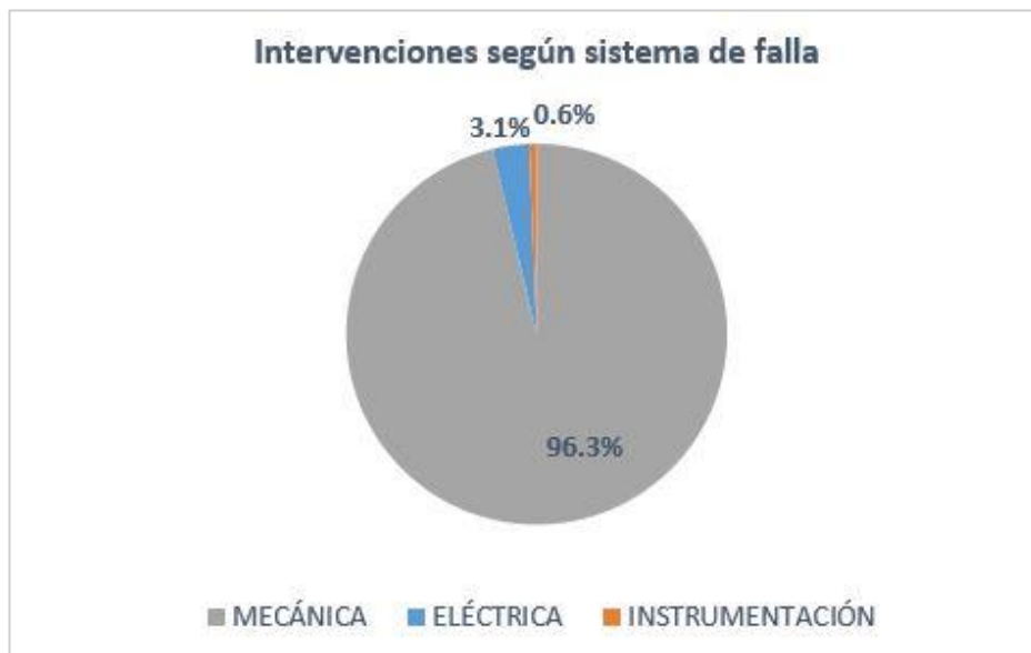
Figura 4.3 Sistemas de falla de las bombas centrífugas horizontales WARMAN 6"X4" AH
