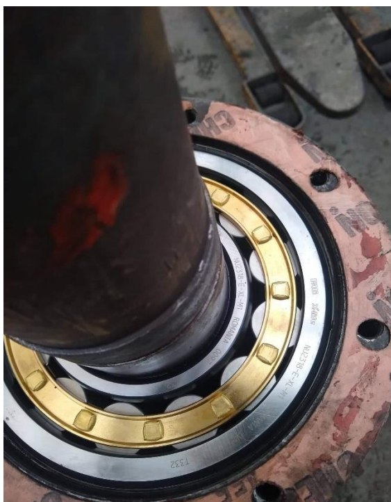
Figura 4.22 Mantenimiento de cilindro portarodamiento
