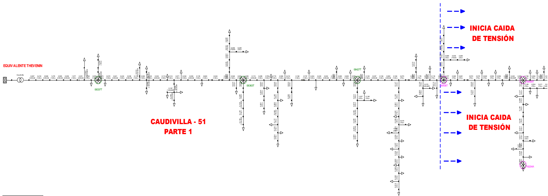
Fig. 23- Área con caída de tensión en alimentador Caudivilla-51 Fuente: Elaboración Propia
