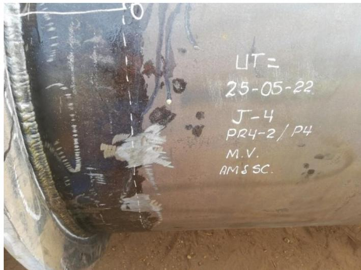
*Figura 35: Aprobación de junta soldada por el método de Ultrasonido*
