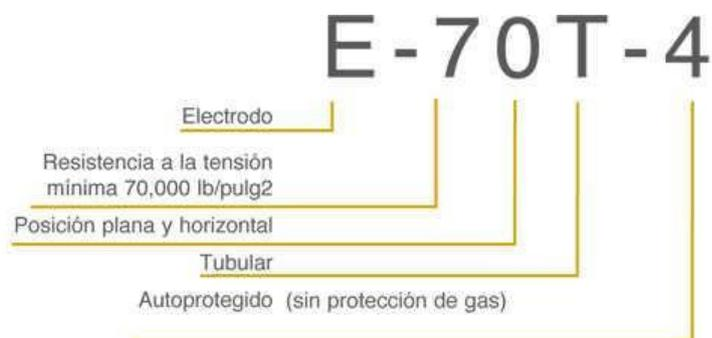
Figura 17: Clasificación de electrodos FCAW
