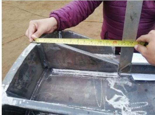
*Figura 30: Control Dimensional en cartelas de refuerzo*
