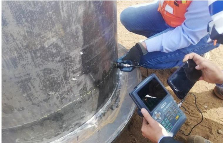
*Figura 34: Aplicación de la técnica de UT en estructura soldada*
