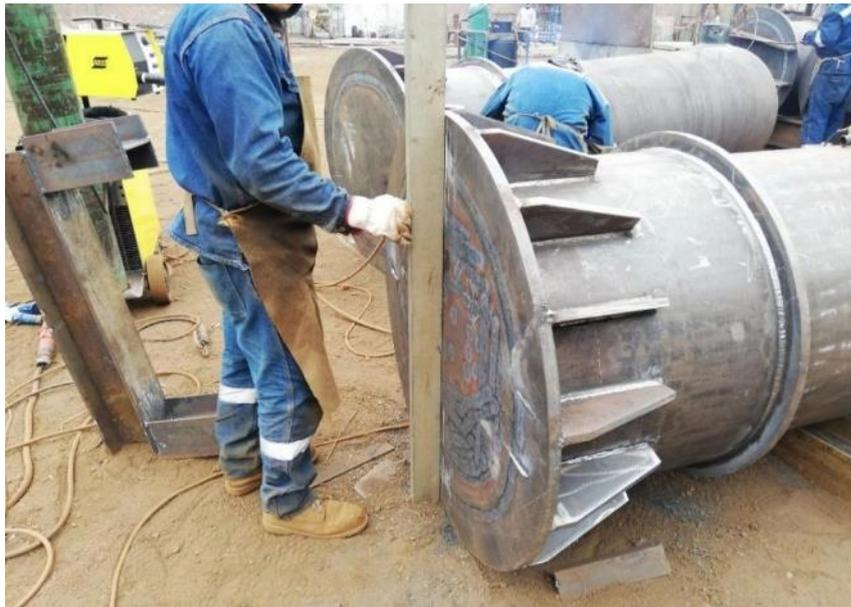
*Figura 29: Discontinuidades por deformación termina minimizados, planitud dentro de tolerancia con un mínimo trabajo de enderezado*
