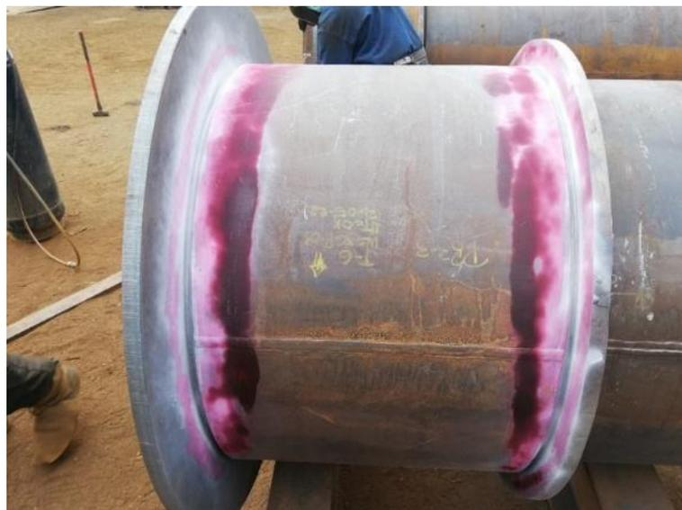
*Figura 24: Aplicación de tintes Penetrantes es pase raíz de soldadura*
