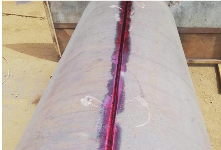
*Figura 23: Aplicación de tintes Penetrantes es pase raíz de soldadura*
