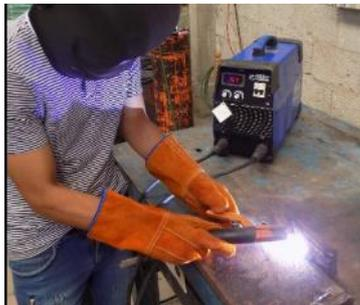
*Figura 4: Proceso de Soldeo SMAW*
