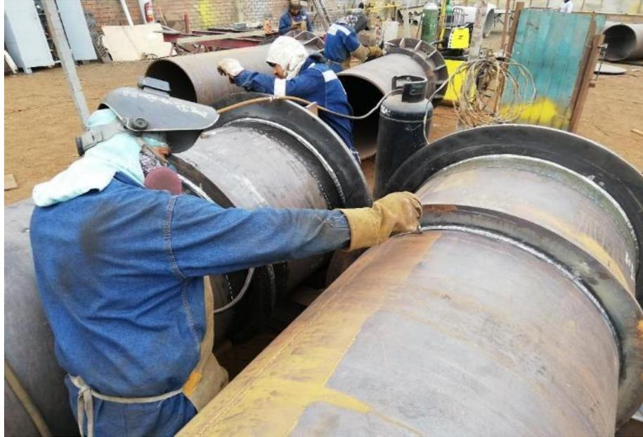
*Figura 28: Control de Temperatura con uso de tiza térmica, método manual*
