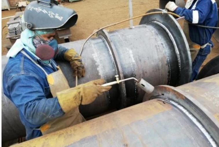
*Figura 26: Pre calentamiento de estructura previo a soldeo de relleno y acabado*
