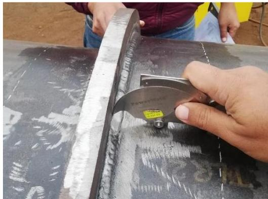
*Figura 32: Control de cateto de Soldadura en junta a Filete*
