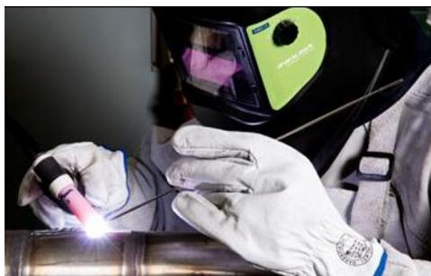
*Figura 5: Proceso de Soldeo GTAW*
