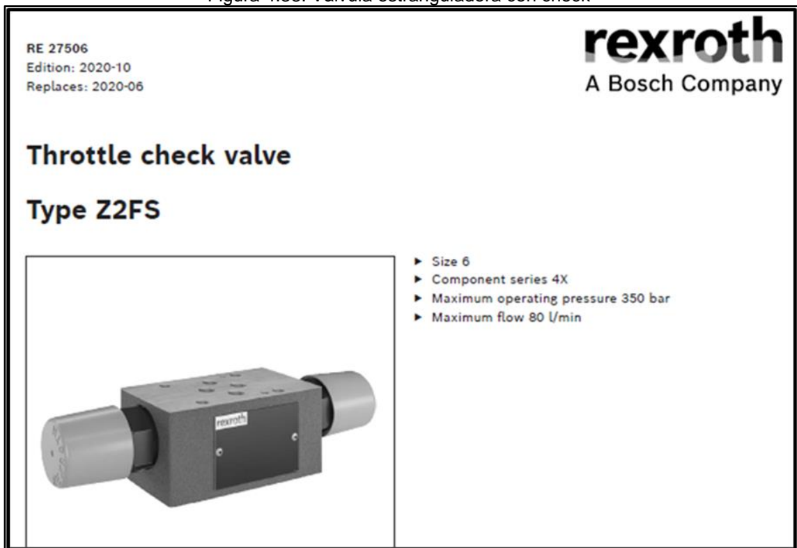
Figura 4.38: Válvula estranguladora con check
