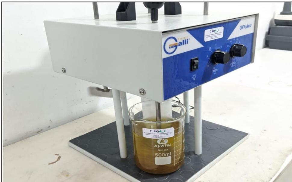
Figura 9. Agitación de la cáscara reticulada a 200 rpm durante 21 horas
