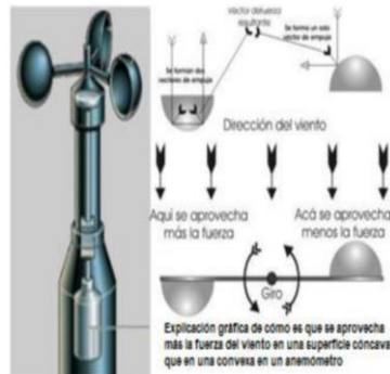
Fig 2. Veleta de anemómetro de cazoletas
