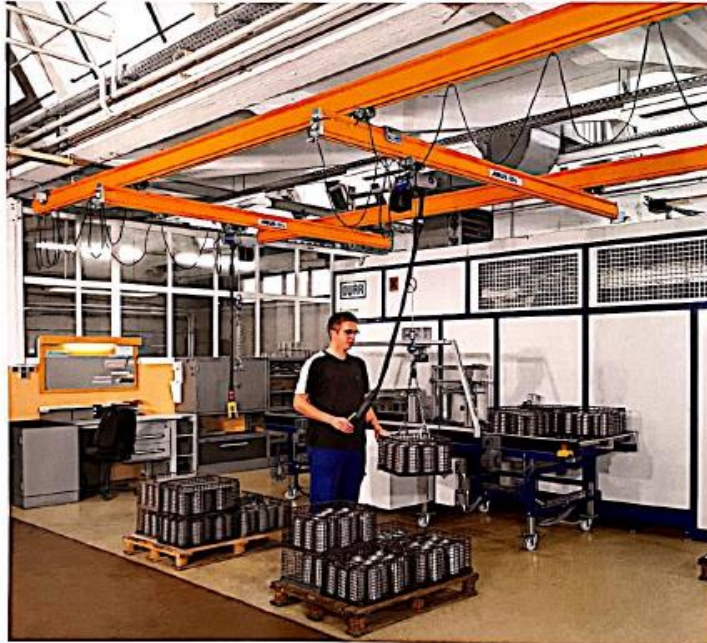
Puente grúa monorraíl EHR ABUS.
