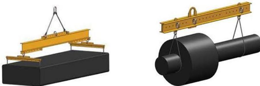
Para casos en que se envían a fabricar, estas vigas, para una pieza o equipo especial y específico, y puedan ser utilizados, el supervisor ejecutante de la maniobra de izaje, deberá presentar el diseño estructural, firmado por un ingeniero mecánico o civil habilitado, a las áreas de seguridad e higiene industrial, para dar conformidad.
