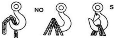
Si el gancho es cargado de modo excéntrico, o si la carga es aplicada en cualquier parte fuera del centro del punto de carga del gancho o en la punta, la carga máxima de seguridad se reducirá considerablemente.
