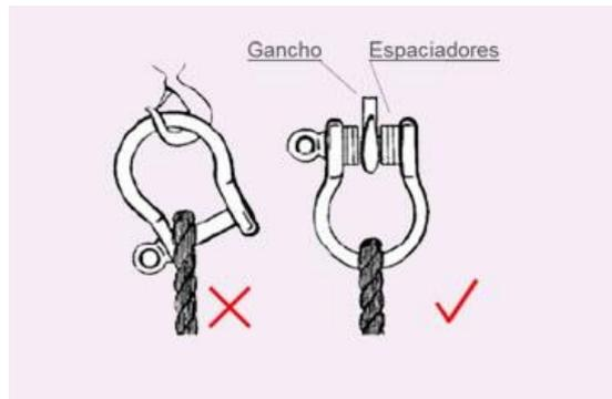
Cuando un grillete es usado para conectar dos eslingas cargadas simétricamente a un gancho de elevación, se usará un grillete lira de forma que estas se coloquen sobre el cuerpo de la lira y el gancho directamente al pasador, teniendo en cuenta que el ángulo máximo entre los ramales nunca excederá de 120°.
