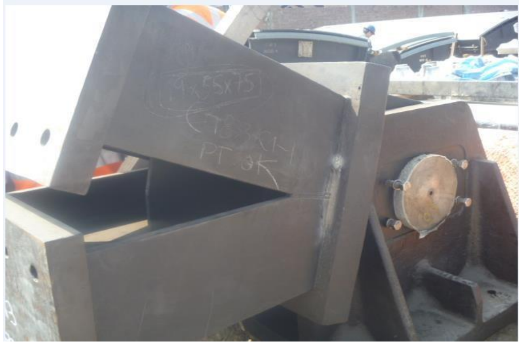
FOTO N° 5.7. TRUNNION ENSAMBLADO CON SOPORTE DE TRUNNION. Fuente: Propia
