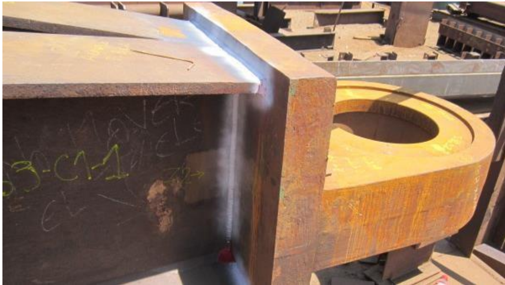
FOTO N° 5.8. TRUNNION ENSAMBLADO CON PANTALON DEL BRAZO. Fuente Propia.
