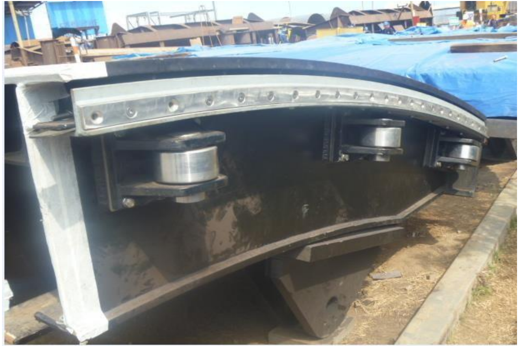
FOTO N° 5.9. MODULO DE COMPUERTA CON RUEDAS LATERALES Y SOPORTE DE SELLO LATERAL. Fuente: Propia.
