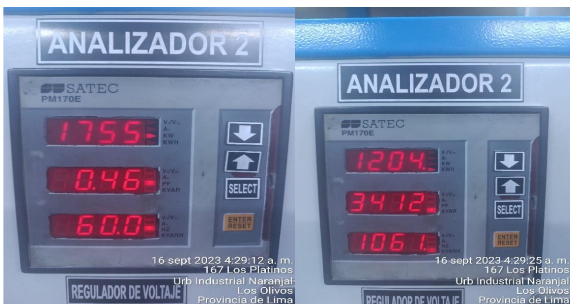
Figura N°79 Perdidas a corriente nominal y Perdidas reactivas a corriente nominal, Fase 2 de la prueba, 100 kVA
