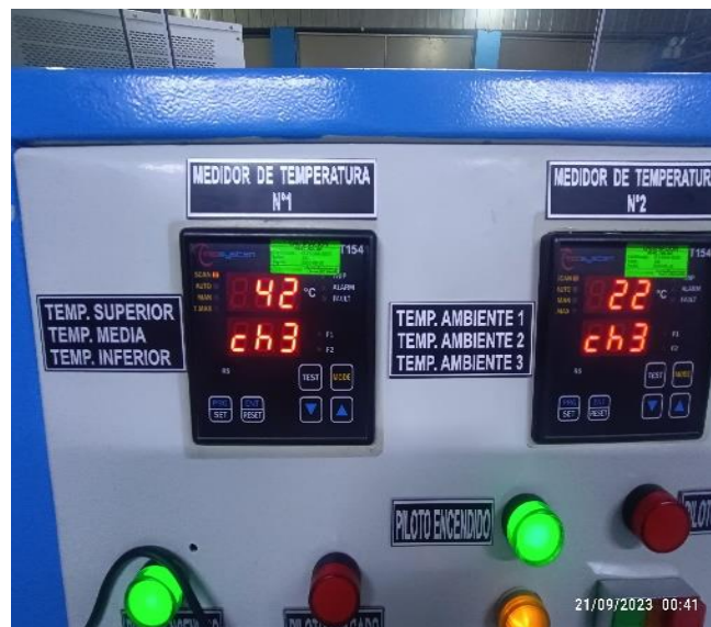
Figura N°130 Temperatura inferior y ambiente N°3, en el transcurso de la prueba, 160 kVA
