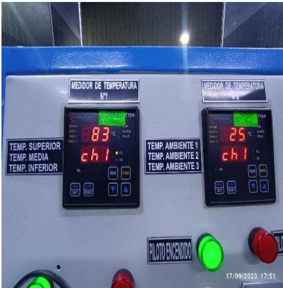
Figura N°100 Temperatura superior y ambiente N°1, en el transcurso de la prueba, 167 kVA
