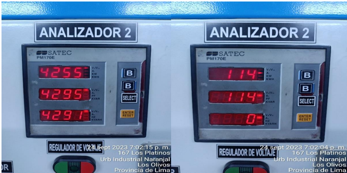
Figura N°162 Tensiones a corriente nominal y Corrientes nominales, Fase 2 de la prueba, 15 kVA
