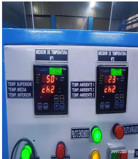
Figura N°159 Temperatura media y ambiente N°2, en el transcurso de la prueba, 15 kVA
