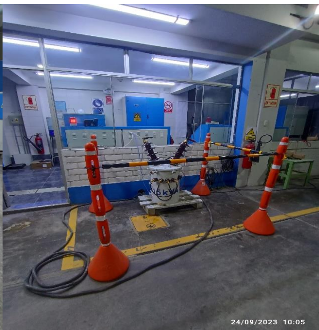
Figura N°157 Transformador en funcionamiento, en etapa de pérdidas totales, 15 kVA
