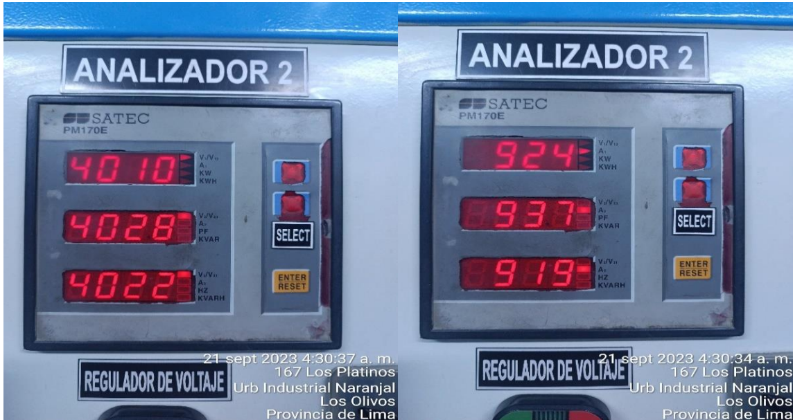
Figura N°133 Tensiones a corriente nominal y corrientes nominales, Fase 2 de la prueba, 160 kVA
