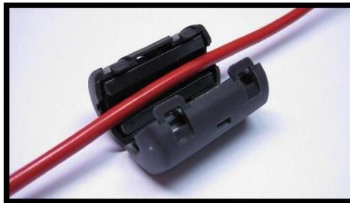
*Figura 40. Núcleo de ferrita*
