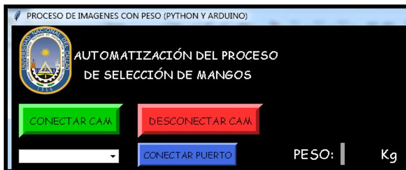
Figura 61. Interfaz gráfica para conectar y desconectar la webcam
