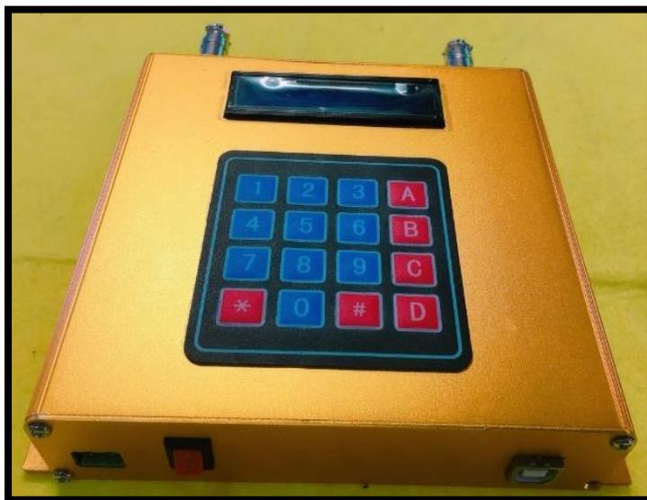
*Figura 2. Implementación del sistema de control de balanzas industriales.
