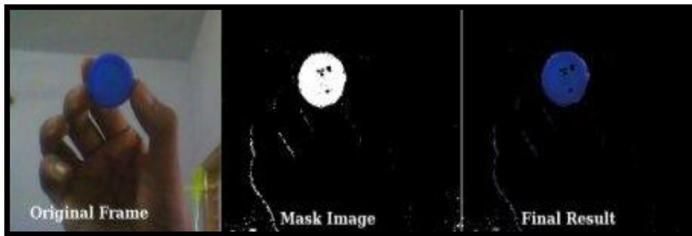
Figura 4. Cambio de espacio vectorial RGB a HSV paso a paso.
