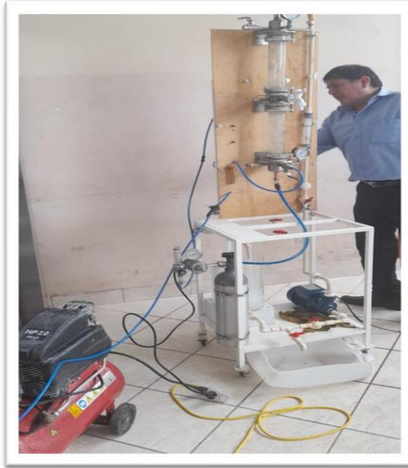
b) Toma de muestra por la parte inferior del Equipo de absorción torre de relleno y medición de la temperatura de las muestras aproximadamente 30 °C.
