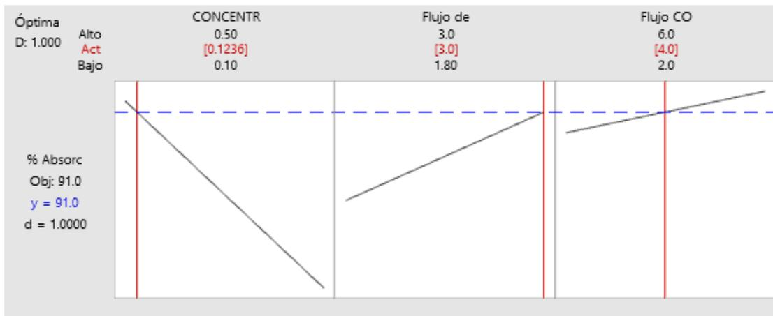
En la figura 16 se grafica la interacción de las variables de operación con respecto a la capacidad de absorción. Se observa el comportamiento de la concentración, flujo de MEA y flujo de CO<sub>2</sub> influyen en la capacidad de absorción del dióxido de carbono.
