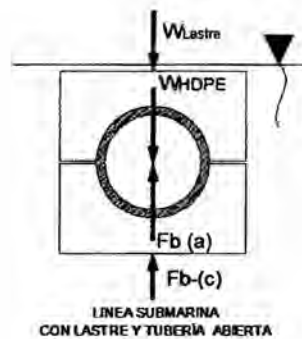
Figura N° 6: Conjunto Tubería – Lastres para hundimiento (Abierta).
