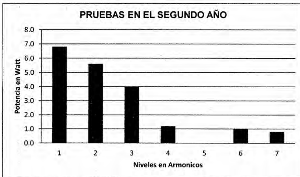
Grafica 7.2 Se aprecia en el segundo año de trabajo de la tarjeta electrónica del excitador su comportamiento en los niveles armónicos en la prueba de encendido directo
