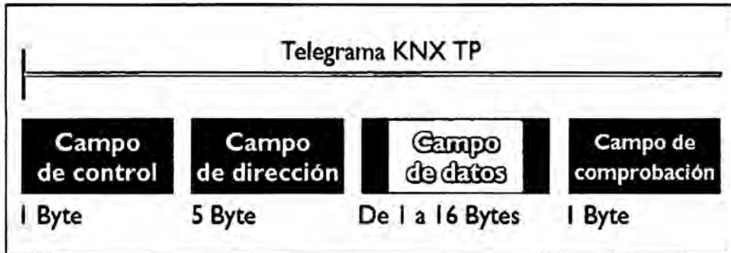
FIGURA 3 – ESTRUCTURA DE TELEGRAMA EN KNX TP
