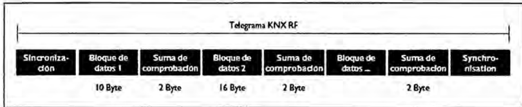
FIGURA 9 – ESTRUCTURA DE TELEGRAMA EN KNX RF
