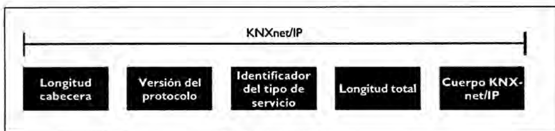
FIGURA 12- ESTRUCTURA DE TELEGRAMA EN KNXNET/IP
