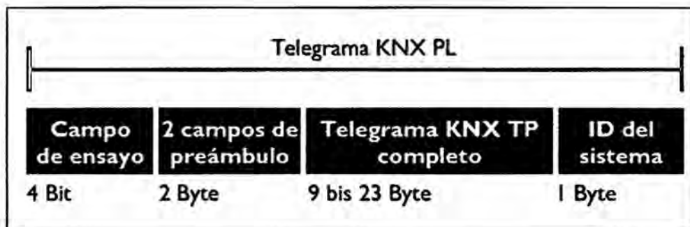
FIGURA 7- ESTRUCTURA DE TELEGRAMA EN KNX PL
