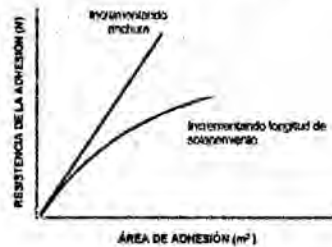
FIGURA 2.8 VARIACIÓN DE LA RESISTENCIA DE LA UNIÓN ADHESIVA INCREMENTANDO ANCHURA Y LONGITUD DE SOLAPAMIENTO.
