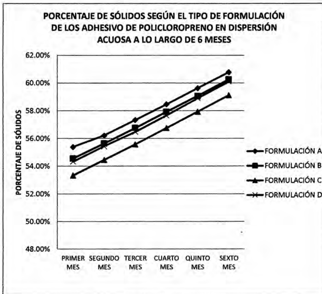
GRÁFICO 5.5 PORCENTAJE DE SÓLIDOS SEGÚN EL TIPO DE FORMULACIÓN DE LOS ADHESIVOS DE POLICLOROPRENO EN DISPERSIÓN ACUOSA A LO LARGO DE 6 MESES
