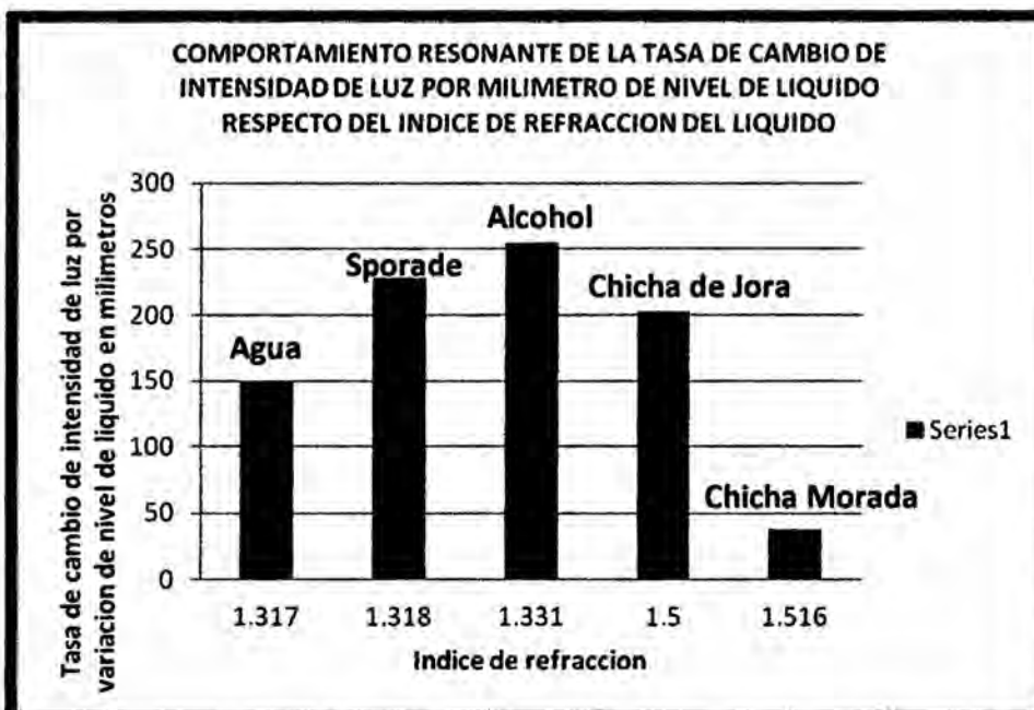
Figura 4.9. Comportamiento resonante de la tasa de cambio de la intensidad de luz por milímetro de nivel de líquido conforme crece el índice de refracción de cada líquido. Fuente: Elaboración del autor.
