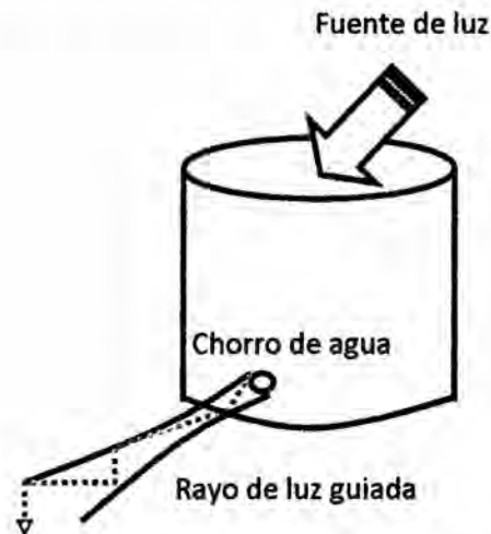
Fig. 2.2 El experimento de Tyndall mostrando que un chorro de agua guiaría un rayo de luz. Fuente: (Newport Corporation, 1986)
