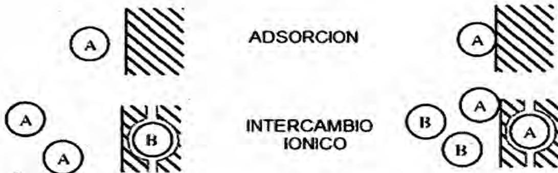
Fig. 1. Representación esquemática de los procesos de adsorción e intercambio iónico. [Adaptada de Agouborde, L. 2008].
