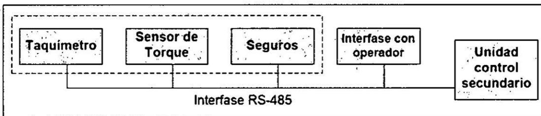
**Figura N° 22 interconexión de bus serial**
