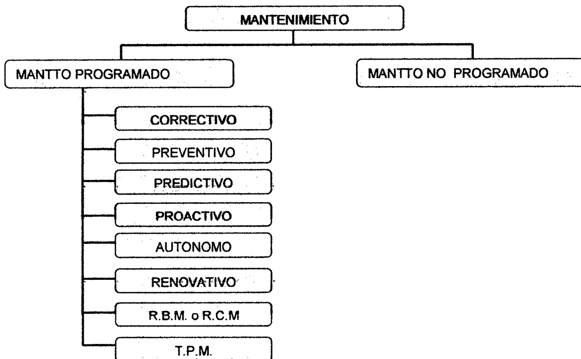
Grafico 1. Clasificación de los tipos de mantenimiento. Fuente: RÓF DE LA EMPRESA
