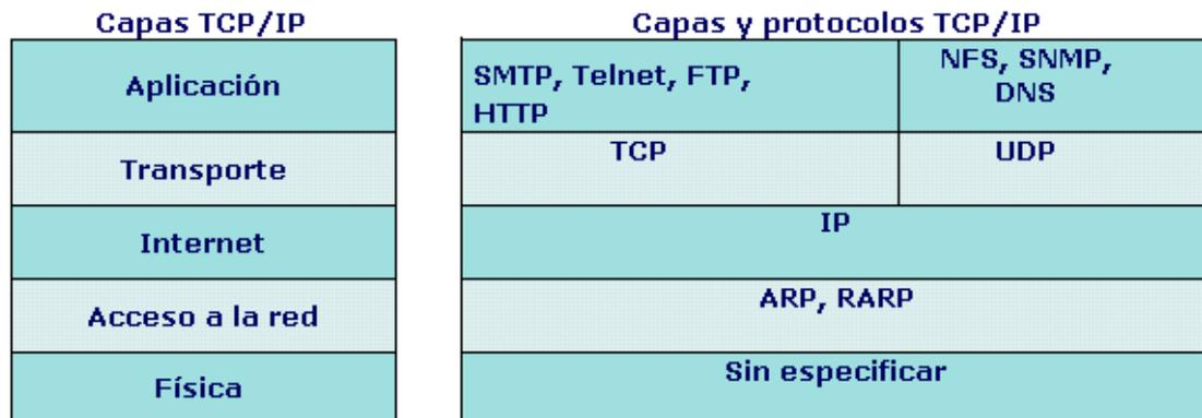
Figura N° 17 Modelo de Referencia TCP / IP y Aplicaciones
