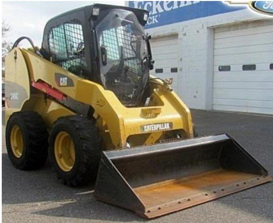
**Figura Nº 3 : MINI CARGADOR FRONTAL Cat 246C**
