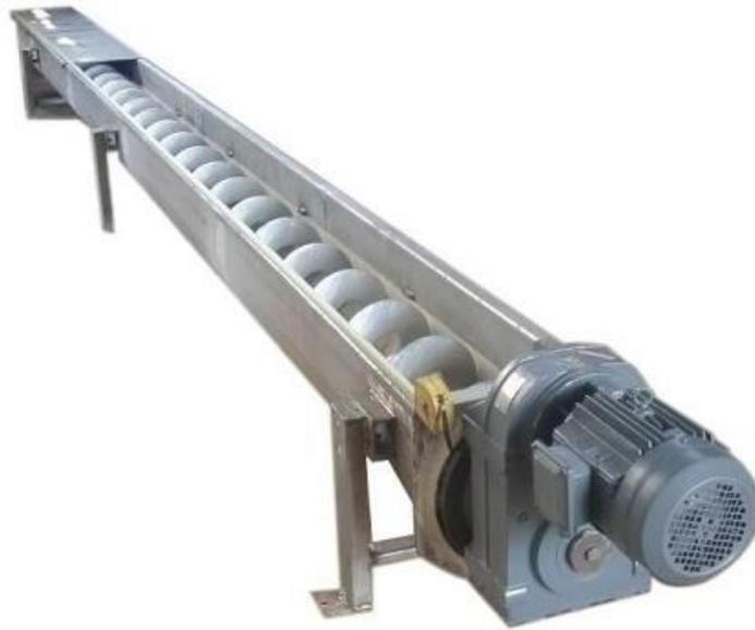
**Figura Nº 10 :** TRANSPORTADOR DE TORNILLO DOSIFICADOR LARGO
