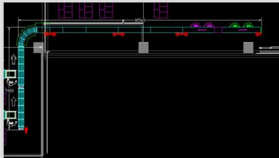
Figura 18. Vista Superior del sistema de bandas transportadoras Fuente: Fuente Propio
