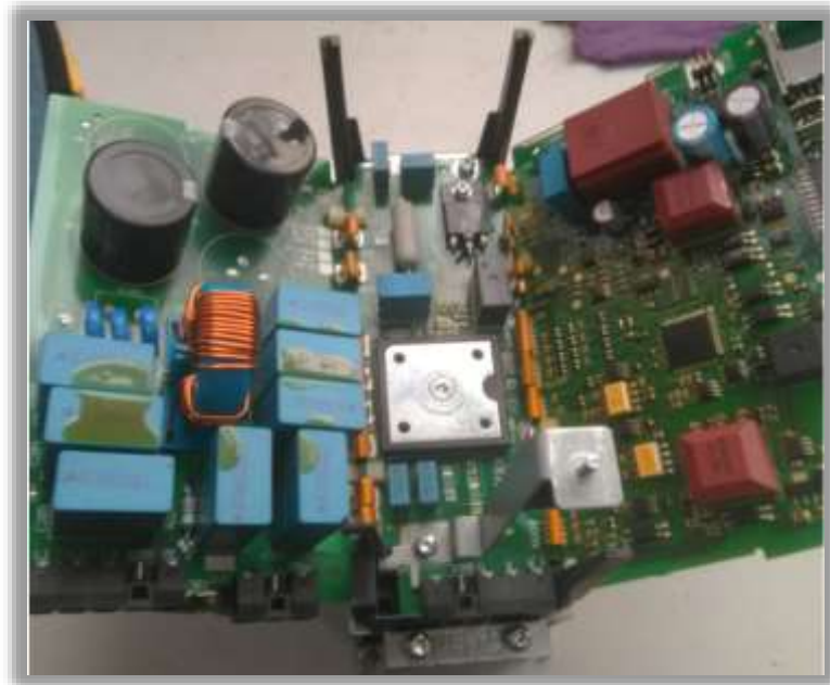
Figura 10. Módulo de poder del Drive G120C Fuente: Elaboración propio.
