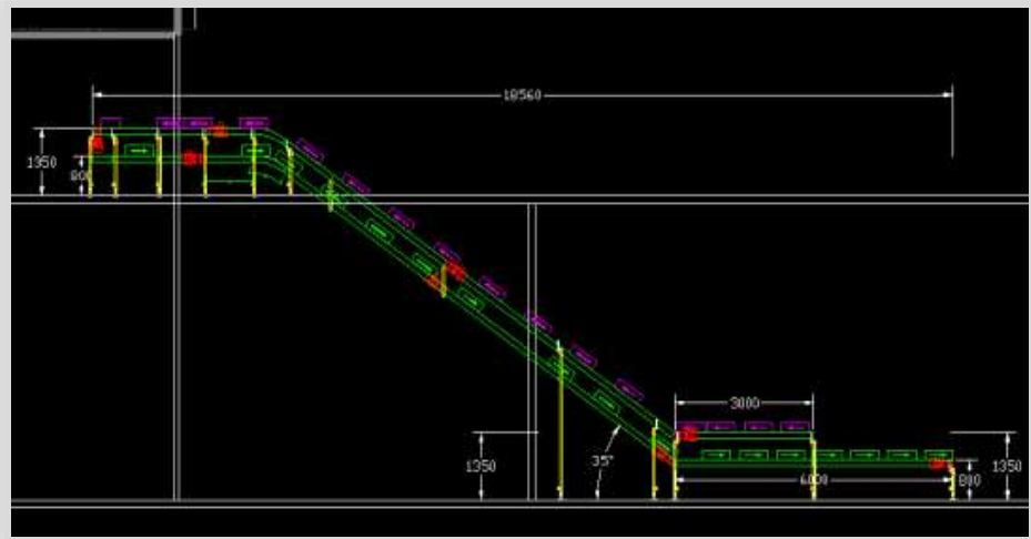
Figura 19. Vista de Perfil del sistema de bandas transportadoras Fuente: Fuente Propio
