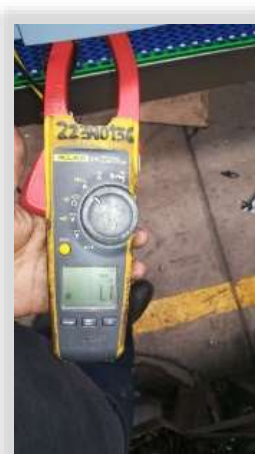
Figura 32. Pinza Amperimétrica Fuente: Elaboración Propia
