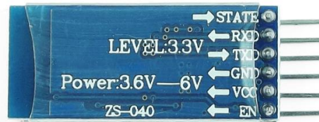
FIGURA 4.20 PINES DEL MÓDULO BLUETOOTH HC-05
