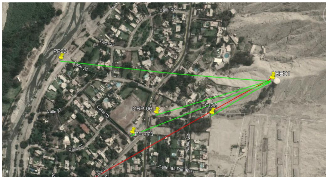
Figura N° 4. 22 Topología tipo estrella para el diseño de radioenlaces en la banda de 400MHz
