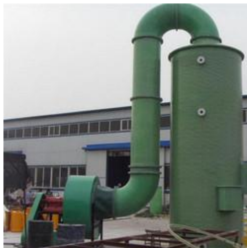
Figura 18. Scruber o lavador de gases
