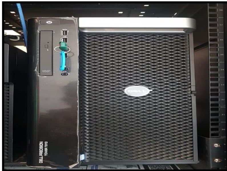
Figura 2.15 Estación de trabajo BMS
