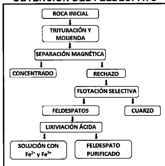
FIGURA N° 2.8 OBTENCIÓN DEL FELDESPATO
