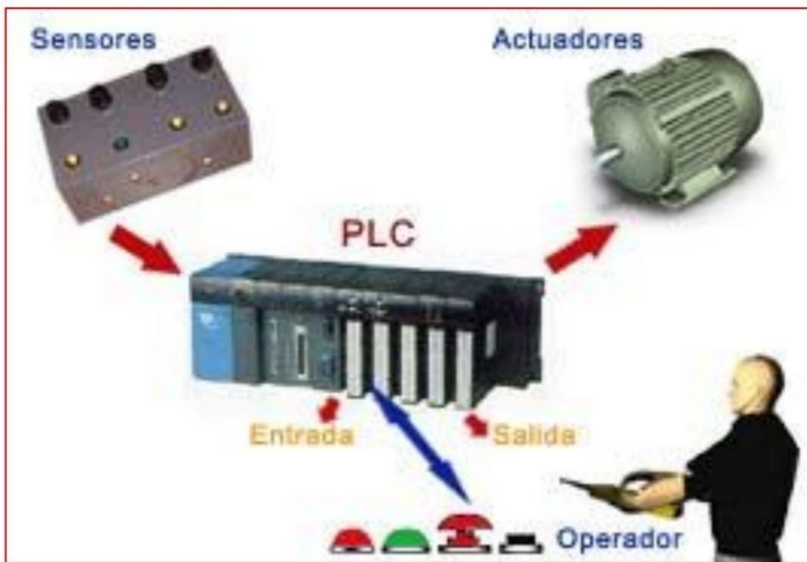
Figura 33. Elementos que Controla el PLC
