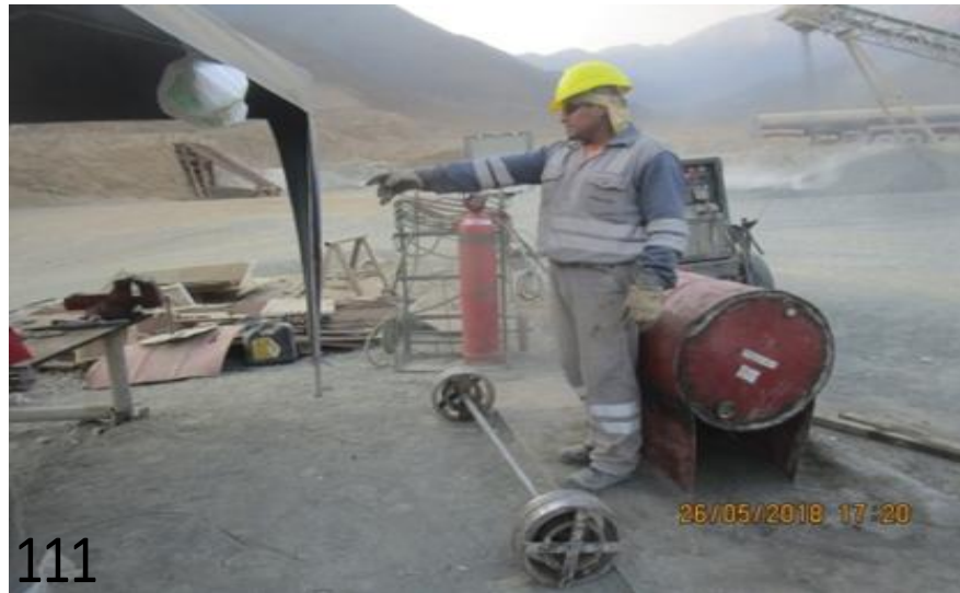
Fotografía 4-3 Construcción de pesas con residuos metálicos
