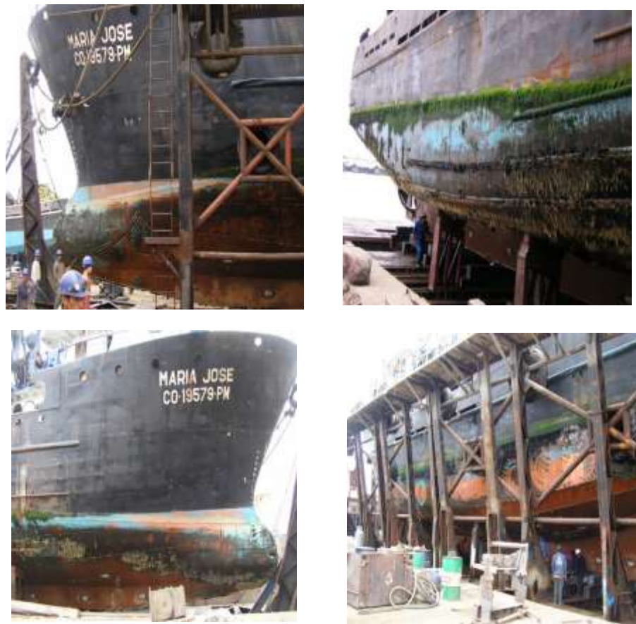
Figura 9 Sistema de Antiincrustantes convencional después de 1 año 3 meses navegando
