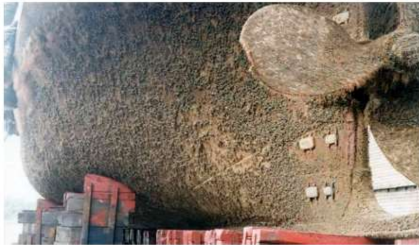
Figura 5 Cascos Afectados por Incrustaciones
