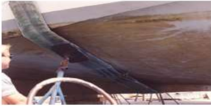
Figura 7 Limo Adherido a un Casco
