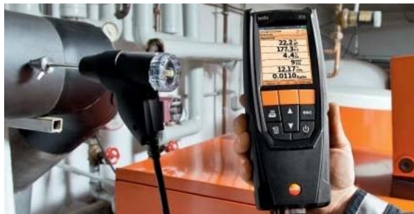
IMAGEN N° 2.10 TOMA DE MUESTRA CON ANALIZADOR DE GASES
