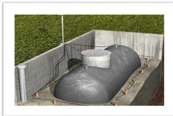
IMAGEN N° 2.12 SISTEMA DE PROTECCION CATODICA POR ANODOS DE SACRIFICICIO
