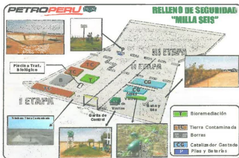
Figura N° 16: Relleno de Seguridad donde se confinan los Residuos Peligrosos
