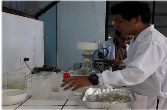
Figura N° 4.11 FILTRACION AL VACIO
