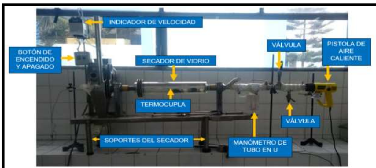
Figura N° 4.3 Descripción de equipo de secador rotatorio de vidrio
