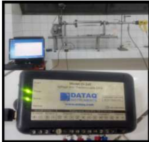
Figura N° 4.4 Data Q conectado e instalado en la computadora del Laboratorio de Investigación de la Facultad de Ingeniería Química
