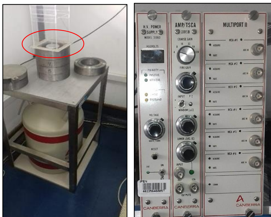
Figura N° 4.5 SISTEMA DE DETECCIÓN DEL GEHP
