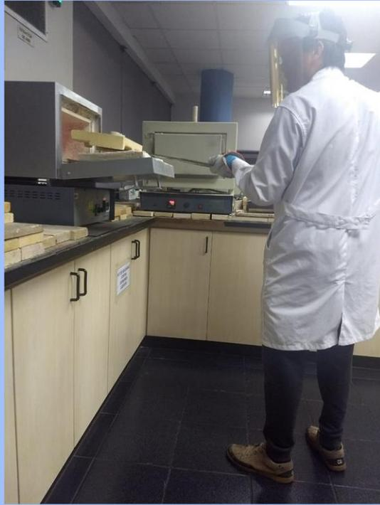
*Figura 25.* Etapa de calcinación en la obtención del óxido de zinc.
