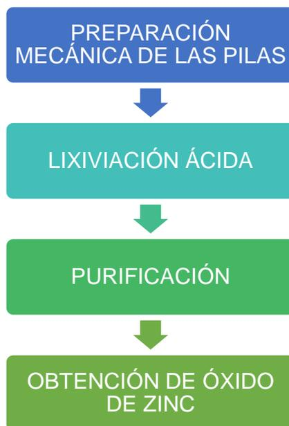
Figura 14. Diagrama de bloques del proceso de obtención del óxido de zinc.
