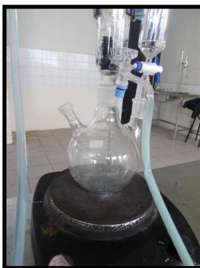
Figura 12. Reactor esférico de tres bocas
