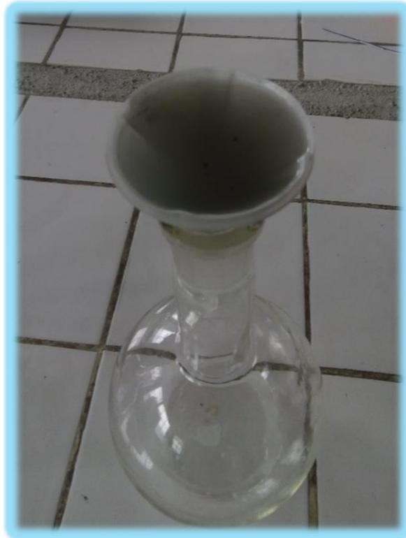
*Figura 19.* Separación de impurezas de la solución.
