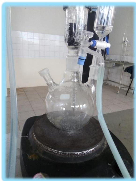
*Figura 16.* Lixiviación con ácido clorhídrico.
