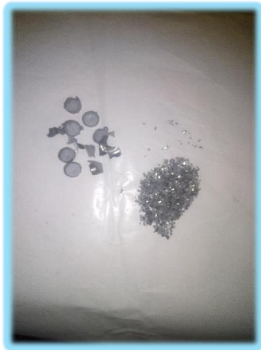
*Figura 15.* Reducción de tamaño de carcasa de la pila.
