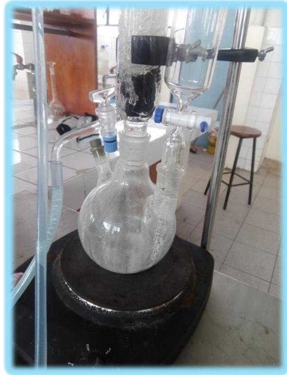
*Figura 17.* Lixiviación con ácido sulfúrico.
