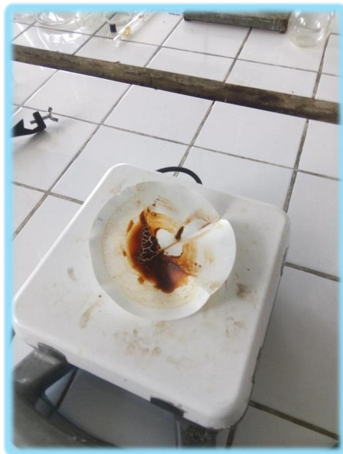
Figura 22. Compuesto de hierro: Jarosita.
