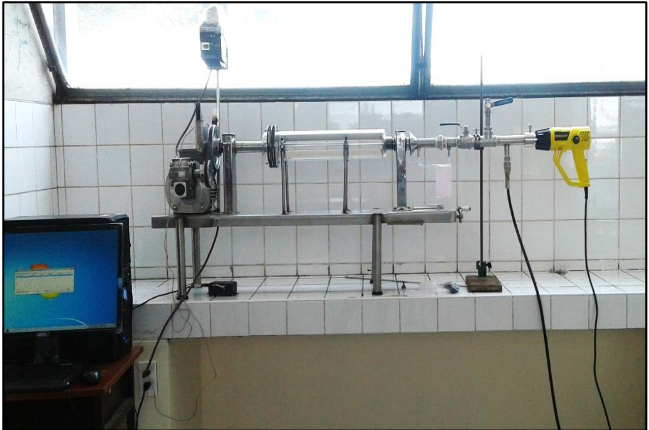
Figura 14. Secador Rotatorio Discontinuo del laboratorio de la facultad de Ingeniería Química. Fuente: Elaboración Propia.
