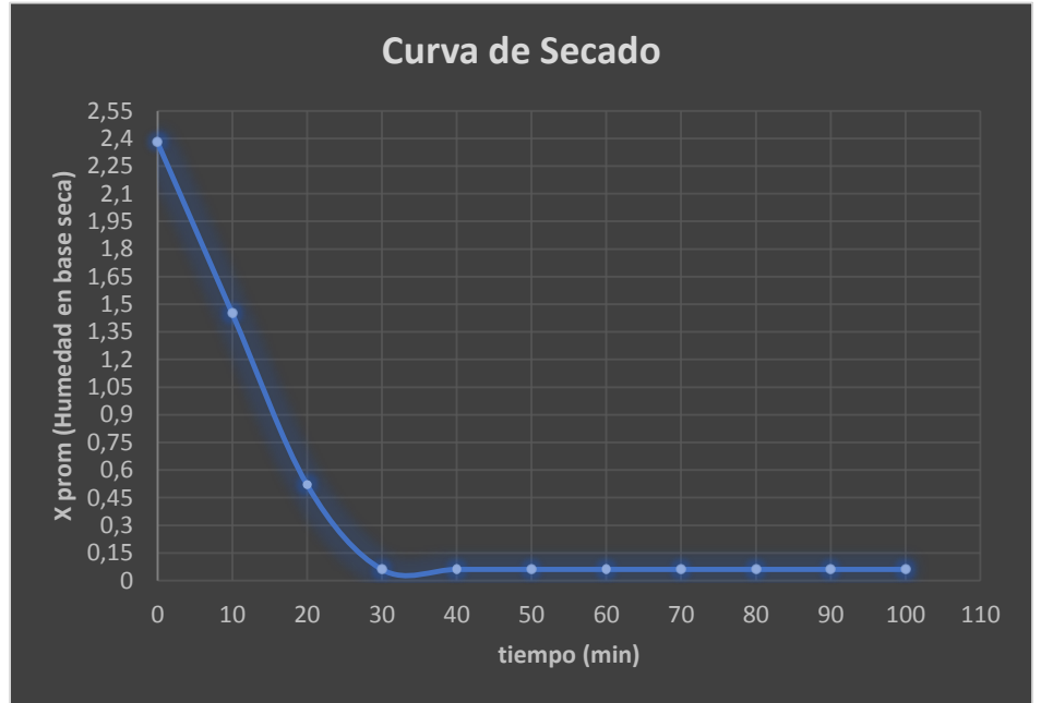
Gráfico 15. Curva de secado a 2mm, 70C y 45.5 m 3 /h. Fuente: Elaboración Propia.
