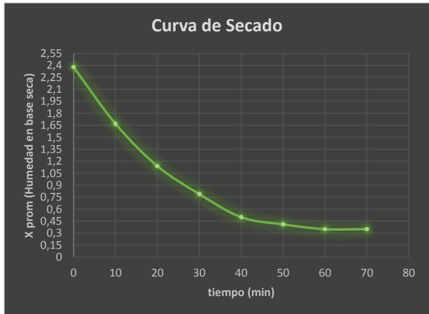
Gráfico 12. Curva de secado a 2mm, 60C y 45.5 m 3 /h. Fuente: Elaboración Propia.
