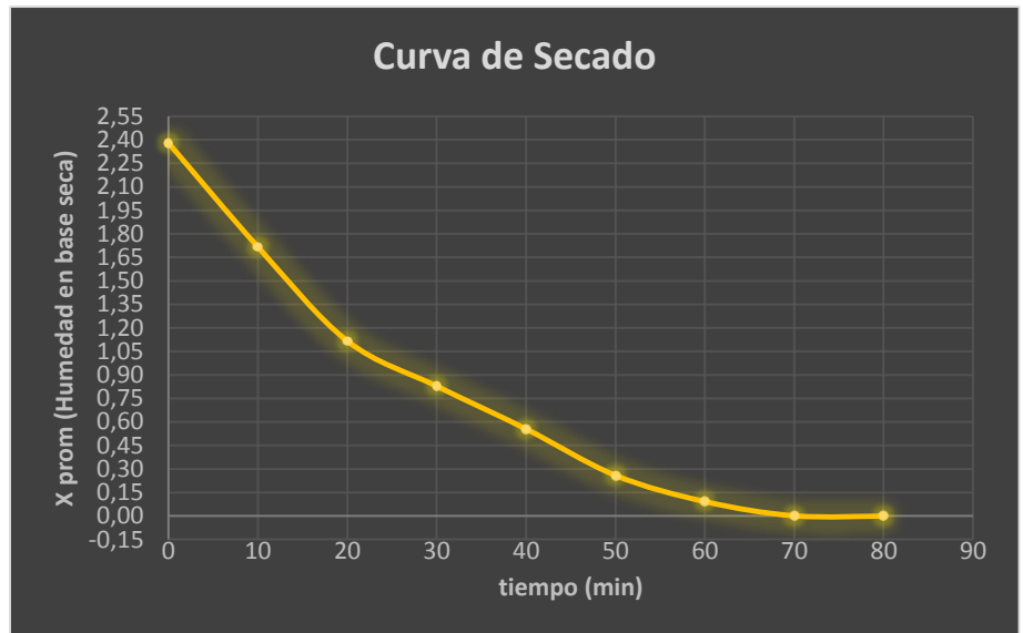
Gráfico 19 Curva de secado a 4mm, 80C y 45.5 m 3 /h. Fuente: Elaboración Propia.
