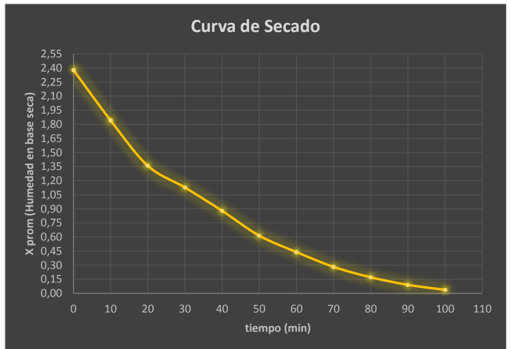
Gráfico 20. Curva de secado a 6mm, 80C y 45.5 m 3 /h. Fuente: Elaboración Propia.
