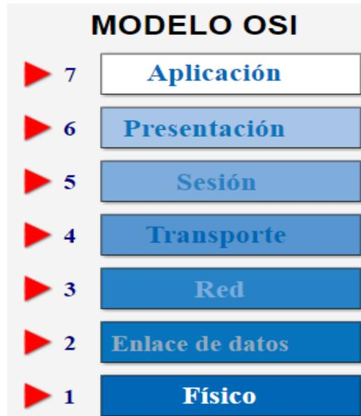
Cada capa tiene su función y debe prestar unos servicios que serán usados por la capa superior. Existen dos tipos de comunicación dentro del modelo OSI, la comunicación horizontal entre dos equipos en la misma capa y la comunicación vertical entre una capa y su superior.
