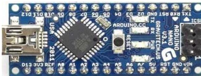
El Arduino Nano es una pequeña versión de la placa Arduino Uno, por lo tanto, también está basada en el ATmega328 (Arduino Nano3.x) o ATmega168 (Arduino Nano 2.x). Tiene más o menos la misma funcionalidad de la Arduino UNO, pero en un paquete diferente. Carece de una sola toma de corriente continua, y funciona con un cable USB Mini-B en lugar de una normal, ofrece la facilidad de ser colocada en una PROTOBOARD, para realizar pruebas.
