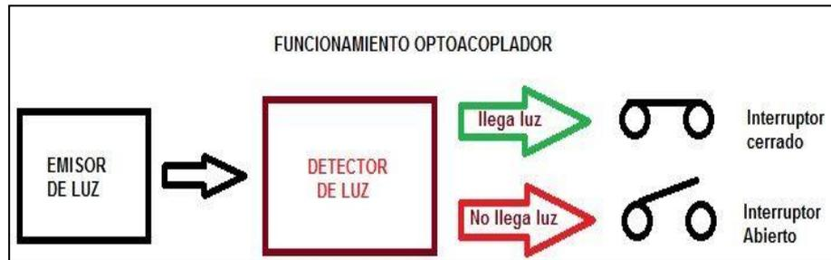
Si combinamos una fuente óptica (generalmente un Led) con algún tipo de detector óptico (generalmente un semiconductor de silicio llamado fototransistor) en un solo encapsulado, el dispositivo resultante es un optoacoplador o interruptor óptico.
