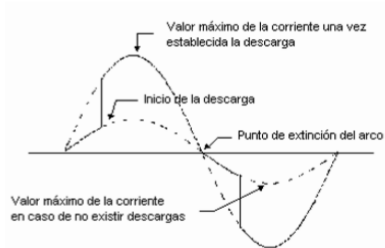
Figura N° 55. Efecto de las descargas sobre la forma de onda de la corriente.
