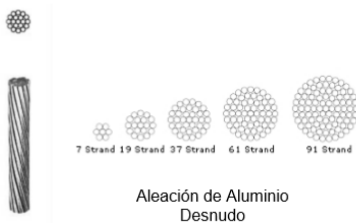
Figura N° 04: Aleación de aluminio desnudo Fuente: Elementos de líneas de transmisión Aérea Francisco M. Gonzáles – Longgat, Mayo, 2007
